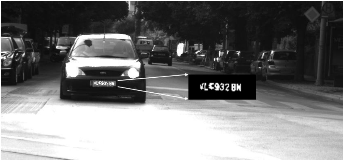
Рисунок 1.7 – Система розпізнавання автомобільних номерів
