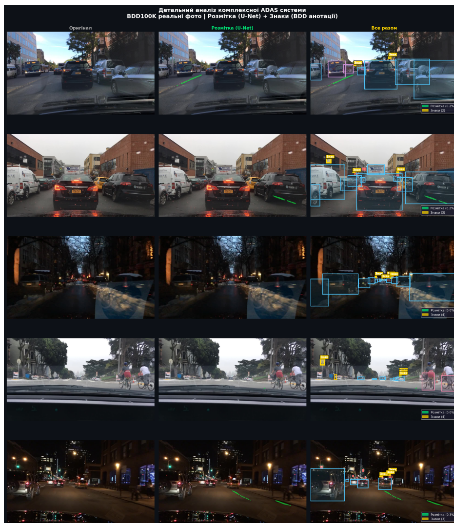
Рис. 4.8 – Комплексна ADAS система на реальних фото BDD100K: зелений - розмітка U-Net, жовтий - знаки, блакитний - автомобілі
