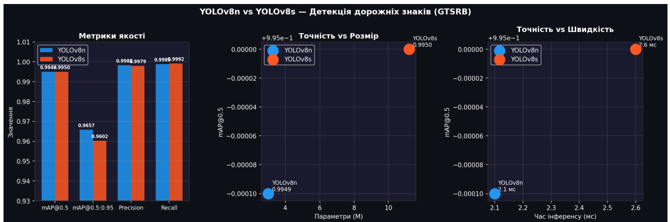
Рис. 4.4 – Порівняння YOLOv8n vs YOLOv8s: метрики якості, точність vs розмір, точність vs швидкість
