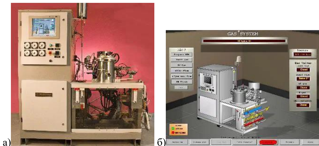
Рис. 3 – Установка паяльної лабораторної печі: а – безпосередньо піч та система управління в шафі; б – програма для керування з комп'ютера;
