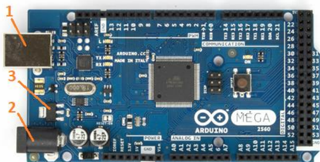
Рис. 17 – Мікроконтролер Arduino Mega 2560 [19]: (1) та (2) – роз’єми USB та живлення відповідно; (3) – стабілізатор напруги;
