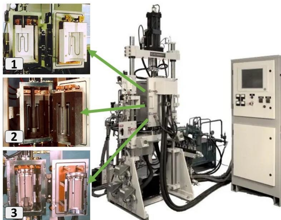
Рис. 5 – механічна випробувальна піч: 1 – керамічна камера; 2 – графітова камера; 3 – металева камера;
