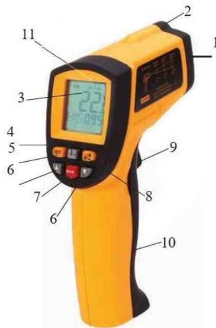
Рис. 8.2. Головні частини пірометра Venetech GM1350 і його функціональні клавіші: 1 – інфрачервоний датчик; 2 – лазерний покажчик зони вимірювання; 3 – рідкокристалічний дисплей; 4 – кнопка STO CAL (збереження результатів); 5 – кнопка SET (підтвердження введеного значення); 6 – кнопки зміни параметрів ▲ і ▼; 7 – кнопка MODE (вибір режиму роботи); 8 – кнопка Вкл./Викл. лазерного покажчика зони вимірювання, підсвічування екрану; 9 – курок для ввімкнення приладу, початку вимірювання; 10 – відсік для джерела живлення (у держаку) [13]
