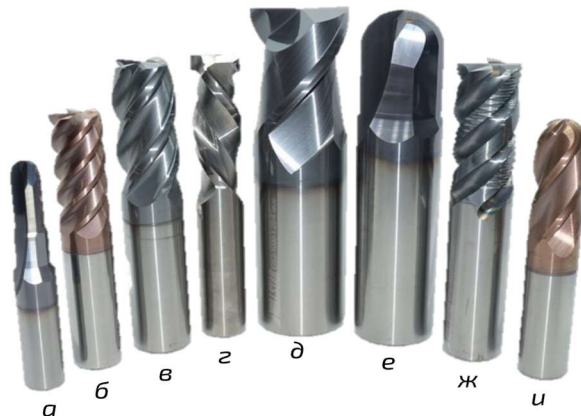
Рис. 3.1. Види кінцевих фрез (зліва направо): а – кульова кінцева фреза (ball end mill); б – циліндрична кінцева фреза з 4-ма канавками (4-flute end mill); в – циліндрична кінцева фреза з 3-ма канавками (3-flute end mill); г – конусна кінцева фреза (taper end mill); д – сферична кінцева фреза (radius end mill); е – кульова кінцева фреза більшого діаметра (ball end mill); ж – чорнова фреза (roughing end mill); и – кінцева фреза з радіусною кромкою (bull nose end mill)
