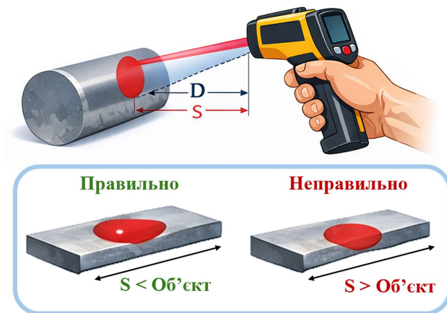
Рис. 8.5. Пошук оптимальної точки вимірювання інфрачервоним пірометром
