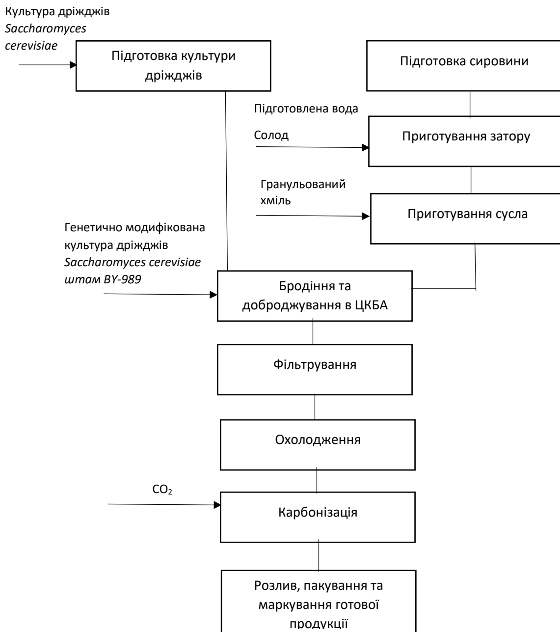
Рисунок 1 - Блок-схема виробництва пива з використанням генетично модифікованих дріжджів подивіться:
