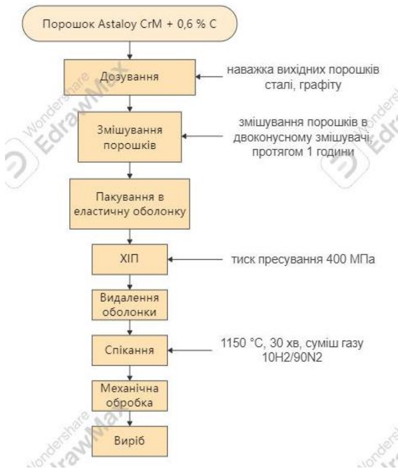
Рисунок 1.3 – Отримання виробів методом холодного ізостатичного пресування
