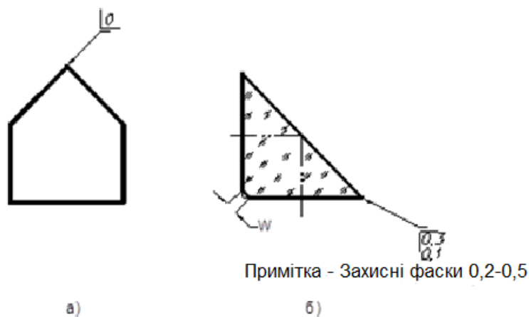
Рис. 4.17. Позначення гострих крайок і захисних фасок
