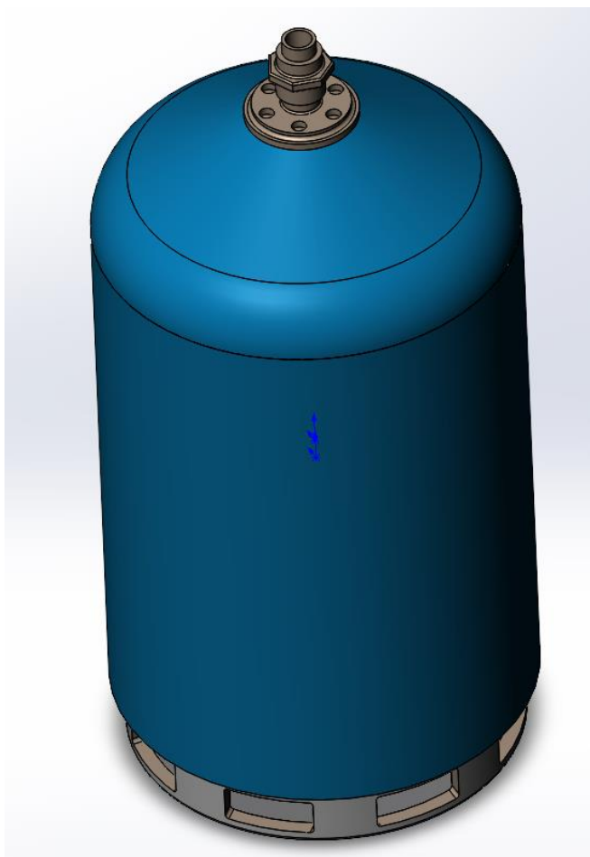
Рисунок 3.9 – Балон з однорідного полімерного матеріалу– 3D-модель (товщина стінки t – 5 мм)
