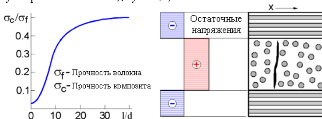
Рисунок. 1.10. – графік залежності міцності від збільшення відношення довжини волокна до його діаметра.
