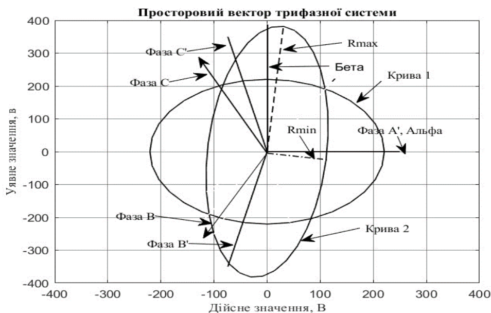
Рисунок 3.7 – Просторовий вектор трифазної системи з наявністю однофазної несправності [5]
