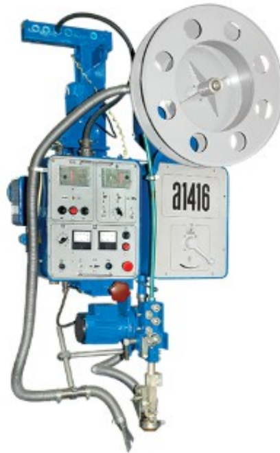
Рисунок 3.1 – Підвісний зварювальний автомат для зварювання під шаром флюсу А1416
