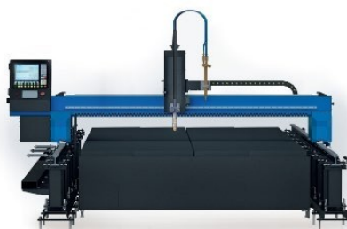
Рисунок 1.3 – Плазморіз марки MARLIN TYPHOON
