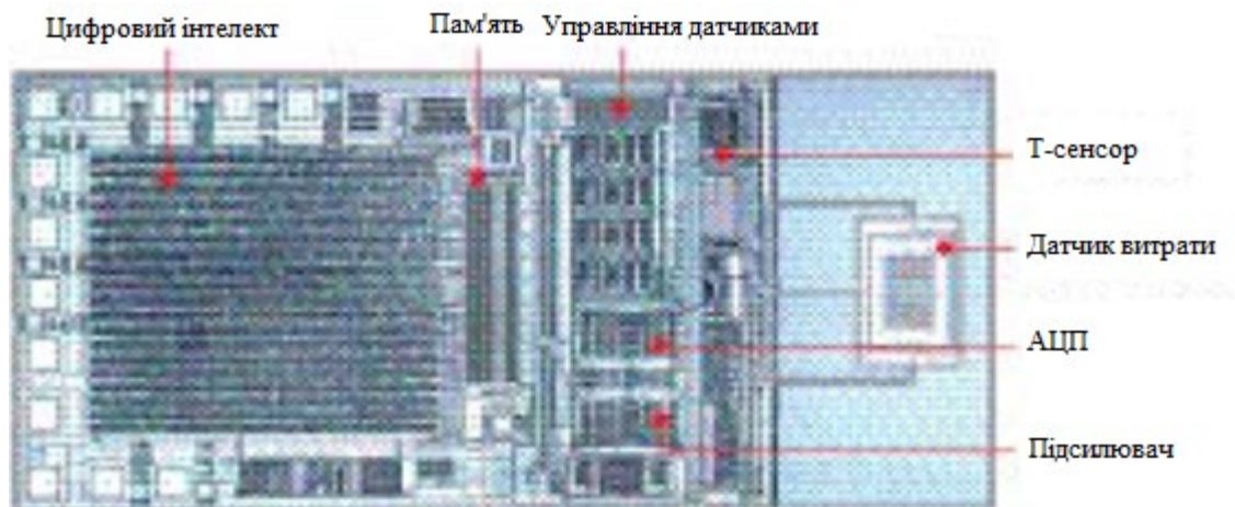
Рисунок 3.2 – Високоінтегрований цифровий чіп датчика потоку
