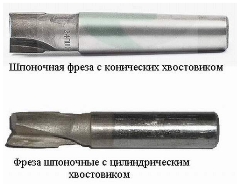
Рис.1.29 – Шпонкові фрези: зверху з конічним хвостиком, знизу з циліндричним.
