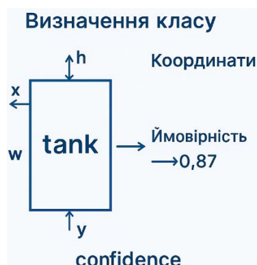
Рисунок 3.18 – Формат результату детекції об'єкта нейронною мережею: координати, клас, довіра
