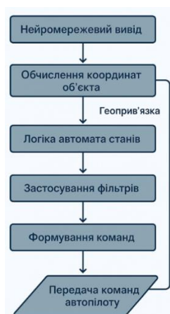
Рисунок 3.19 – Схема генерації керуючих сигналів від виявлення об'єкта до автопілота
