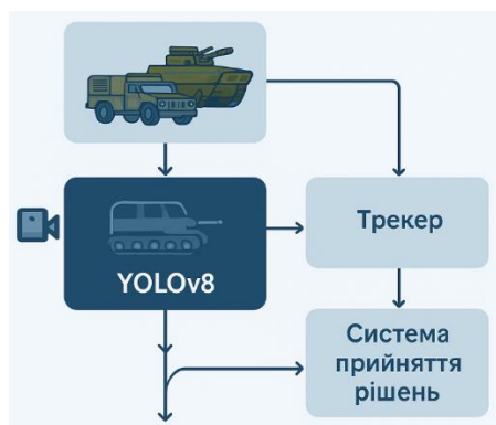
Рисунок 2.3 – Інтеграція YOLOv8 у систему автономного керування БПЛА
