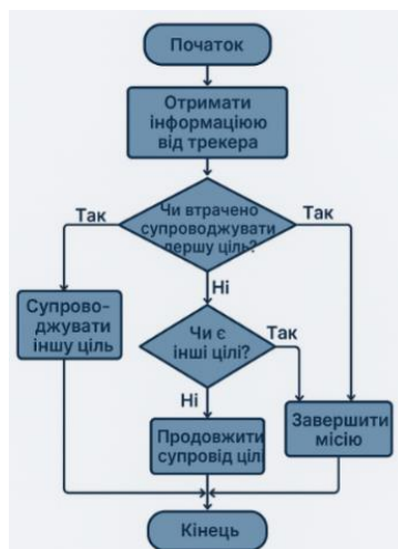
Рисунок 3.20 – Логіка реакції на втрату цілі та багаточисельні об'єкти у системі БПЛА
