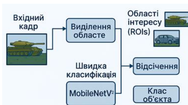
Рисунок 2.5 – Каскадна система на основі ROI та MobileNetV2 для ефективної обробки відеопотоку на БПЛА
