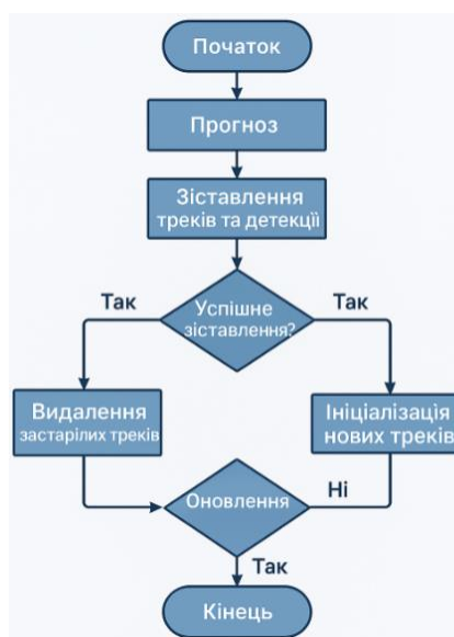
Рисунок 3.16 – Схема оновлення треків у модулі DeepSORT: прогноз, зіставлення, оновлення, видалення
