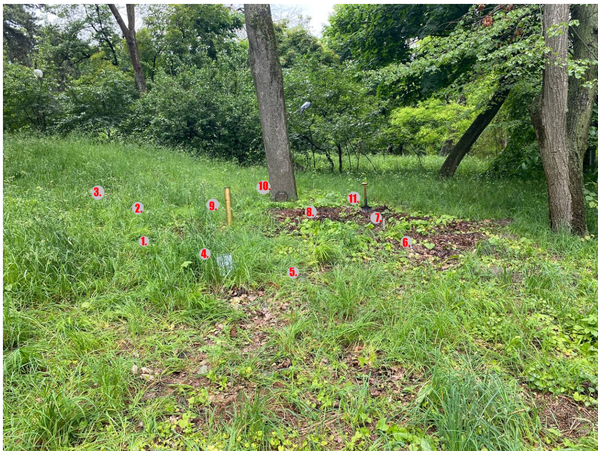
Рис. 4.13. Локалізація об'єктів дослідження для експерименту №3. Номера 1, 5, 6 – кутові відбивачі; 2, 3, 8 – об'єкти округлої форми; 4 – пластина; 7, 9 – снаряди; 10 – бронежилет; 11 – лопата
