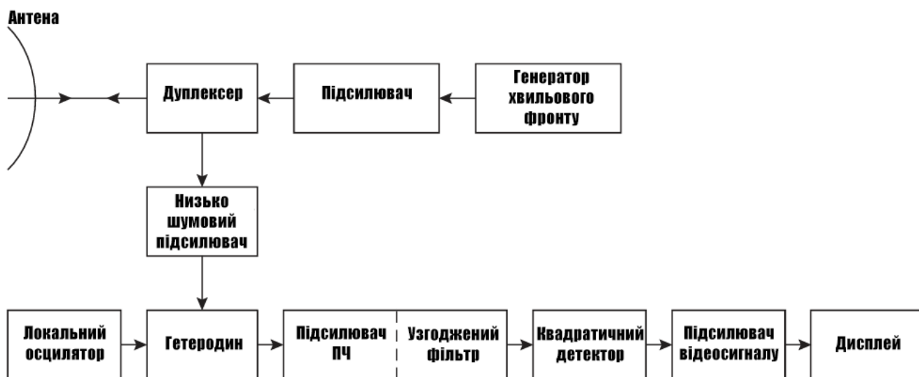
Рис. 1.1. Схема типового моностатичного радару. За [2]
