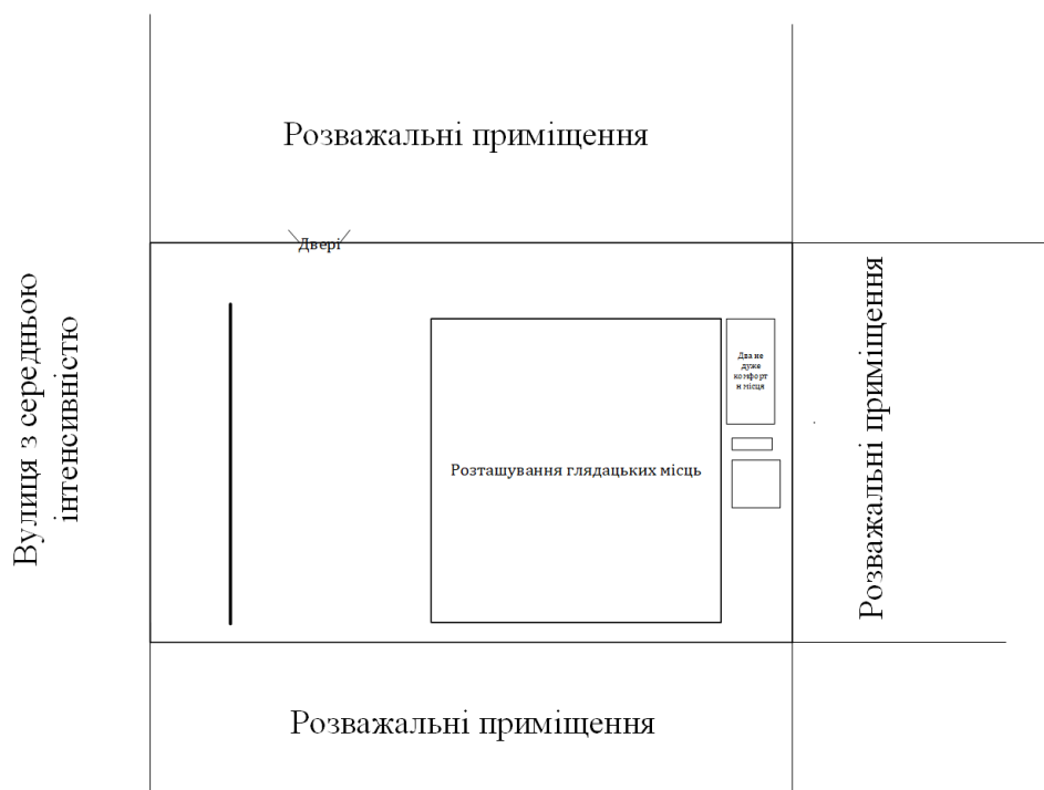
Рисунок 2.3 – Приклад плану розташування глядацької зали кінотеатру в оточенні суміжних приміщень
