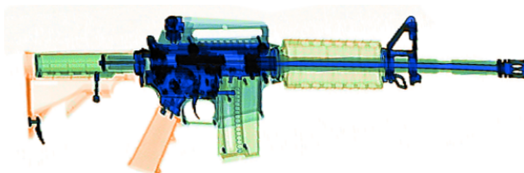
Рисунок 1.5 – Приклад кольорового рентгенівського зображення автоматичної гвинтівки М4, яка виготовлена з різних сплавів металів [5]
