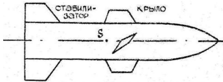
Рис 3.3.4. Аеродинамічна схема «поворотне крило»
