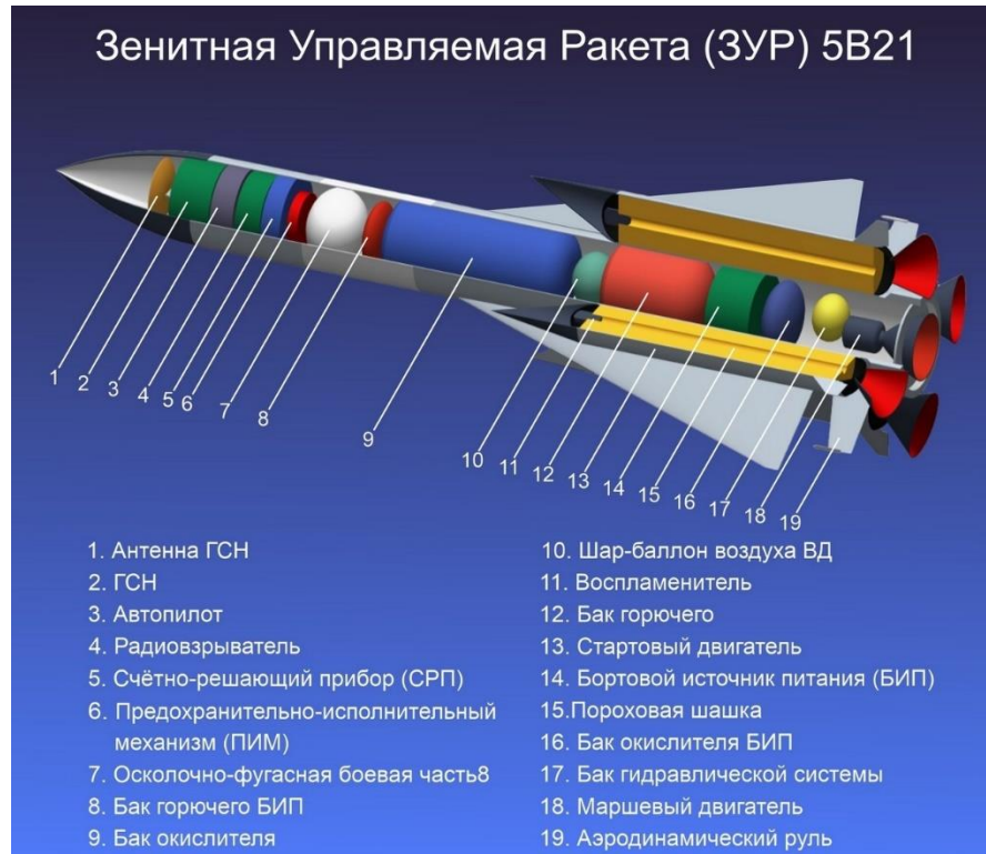
Рис1.2.2. Компонировка ракеты 5B21, яка є частиною комплексу С-200
