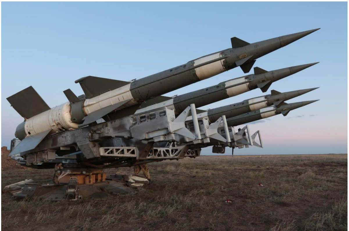
Рис 1.2.1. Пускова установка зенітно-ракетного комплексу С-125 з чотирма встановленими ракетами 5В24
