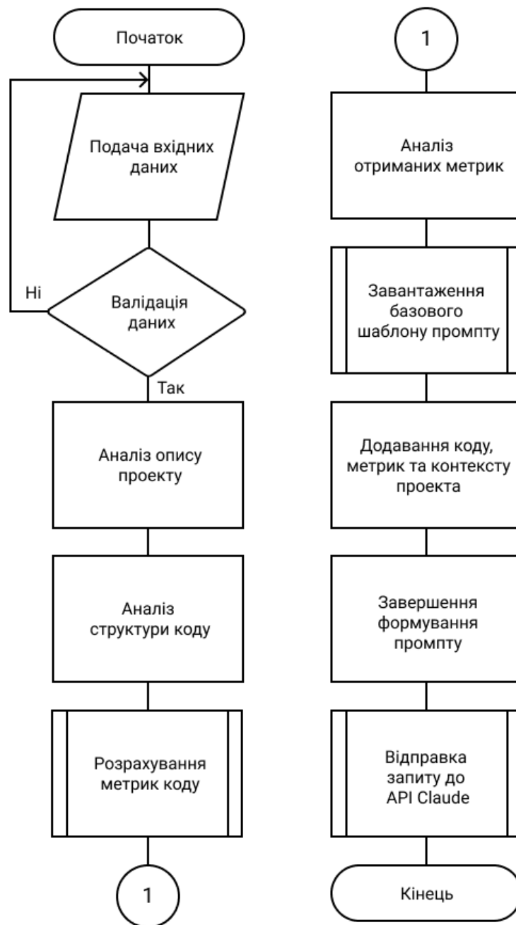
Рис. 2.2. Блок-схема алгоритму формування адаптивного промпту
