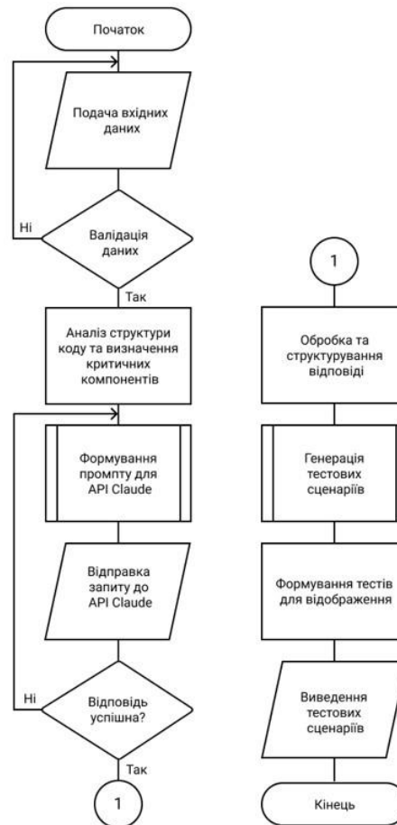
Рисунок 1 – Блок-схема алгоритму автоматизації створення тестових сценаріїв
