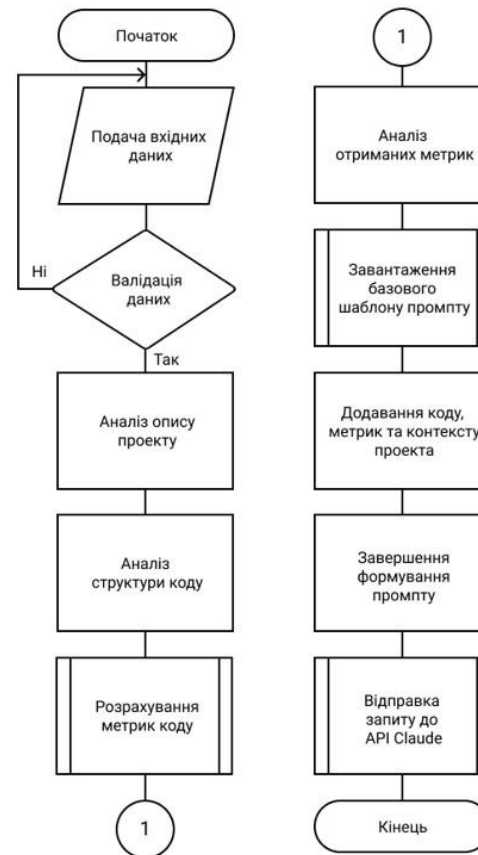
Рисунок 2 – Блок-схема алгоритму формування адаптивного промпту
