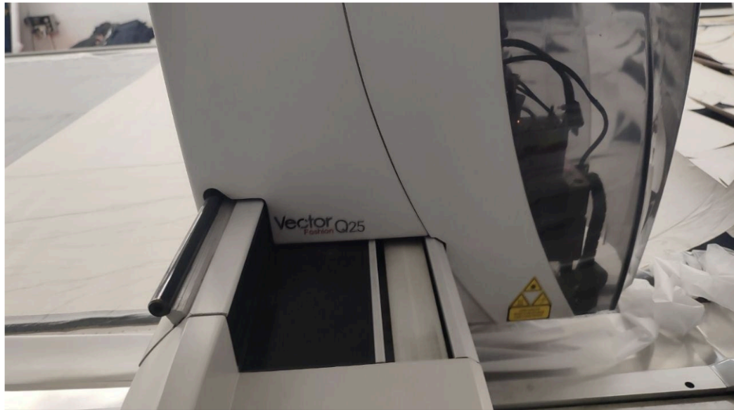
Рис. 1.9 - Різальна головка автоматизованої різальної системи
