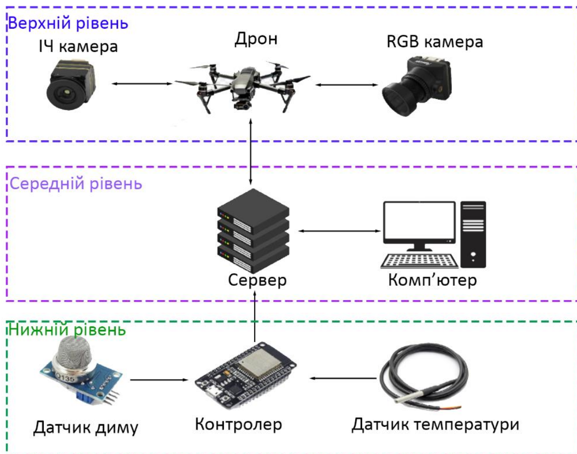
Рис. 2 Структурна схема автоматизованої системи раннього виявлення пожеж у лісових масивах
