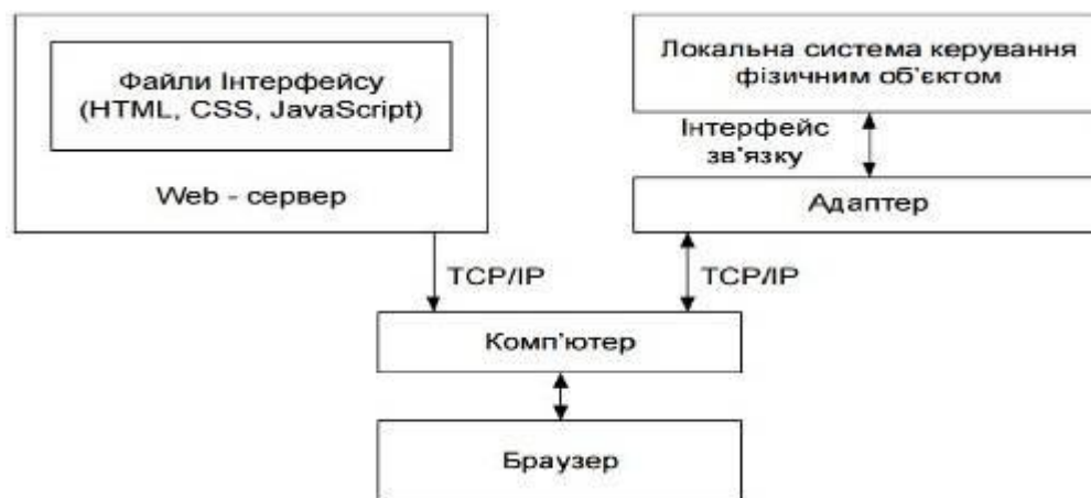
Рисунок 2.1 Загальна структура віддаленого доступу з використанням мережі Інтернет
