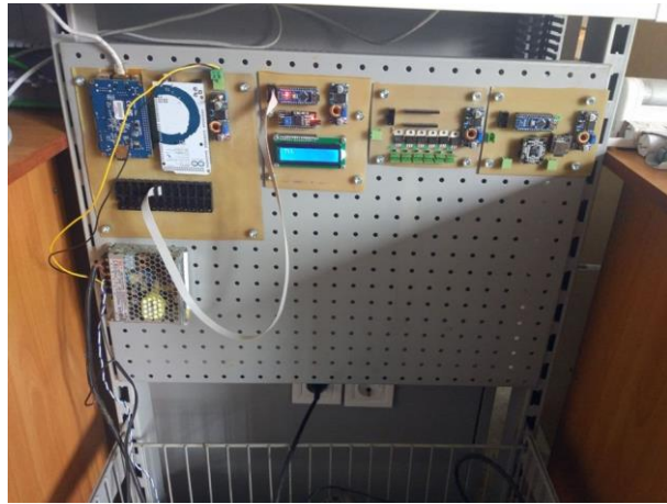
Рисунок 5.2 Стенд моделювання віддаленого моніторингу та управління технологічним процесом (мікрокомп'ютер, мікроконтроллер, модулі)
