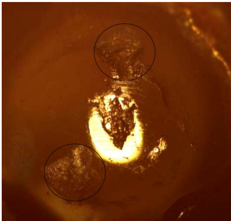
Рисунок 1.12 – Сліди деформування інструменту за виходу на крайову ділянку.
