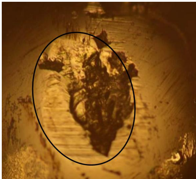
Рисунок 1.14 – Фото робочої частини інструменту з зоною пластичної деформації.
