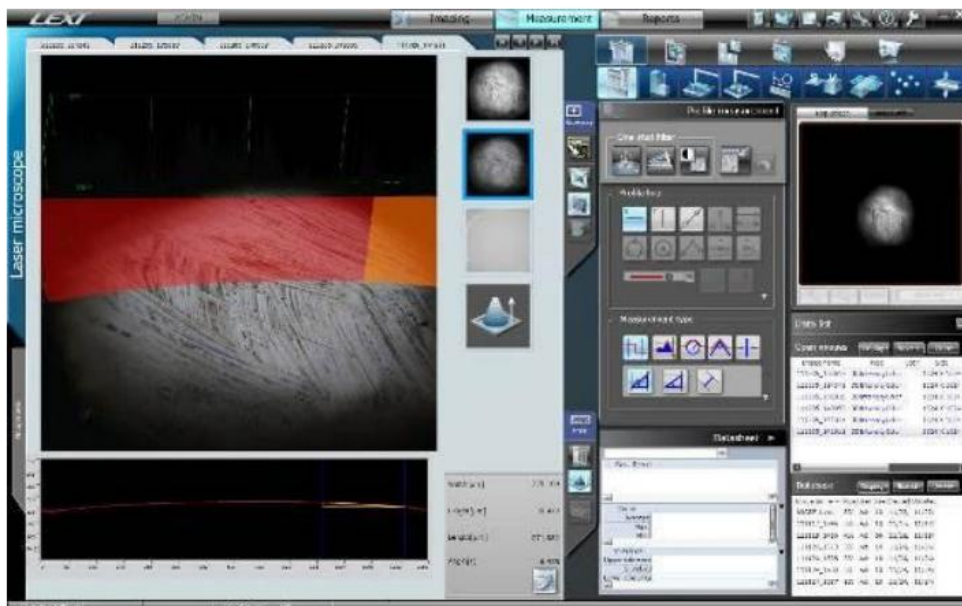
Рисунок 1.9 – Вікно програмного забезпечення Lext із зображенням робочої поверхні інструменту.
