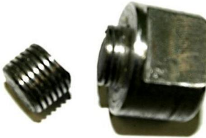
Рисунок 1.16 – Руйнування різьбової ділянки інструменту.
