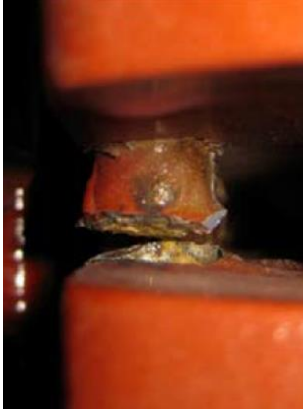
Рисунок 1.13 - Місце розриву стержня ДО [11].
