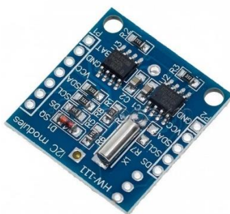
Рисунок 2.9 — Модуль годинника реального часу DS1307
