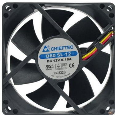
Рисунок 2.10 — Вентилятор 12 В 80x80 мм Chieftec Thermal Killer AF-0825S[21]
