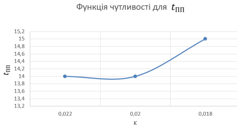
Рисунок 3.42 - Функція чутливості для часу перехідного процесу
