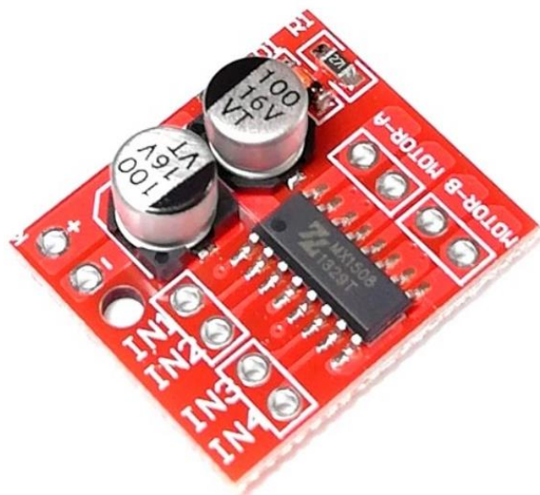
Рисунок 2.3 – Драйвер двигуна MX1508
