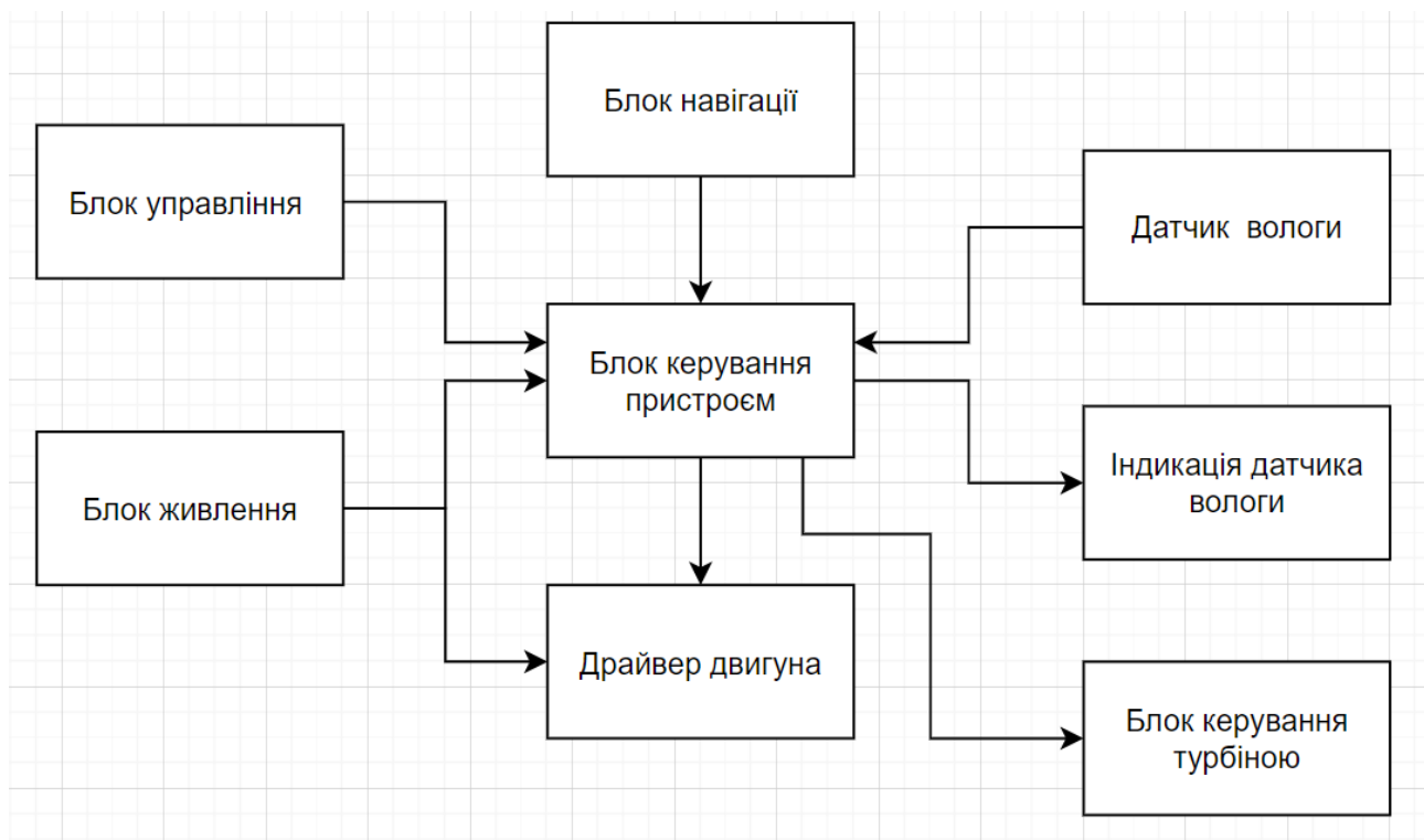
Рисунок 2.1 – Структурна схема системи керування
