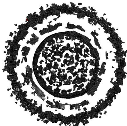
Продовження рис. 4.12 – Кадри дроблення корпусу гранати з концентраторами , що виготовлений із різних марок сталі
