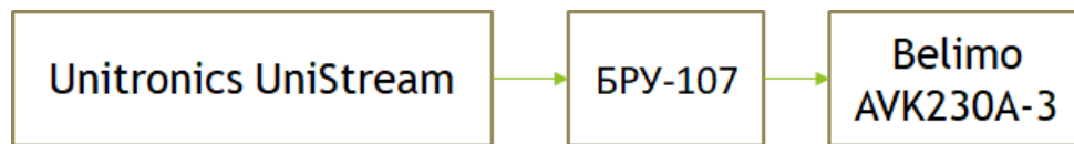
Рис. 2.19 Структурна схема надійності управління рівнем
