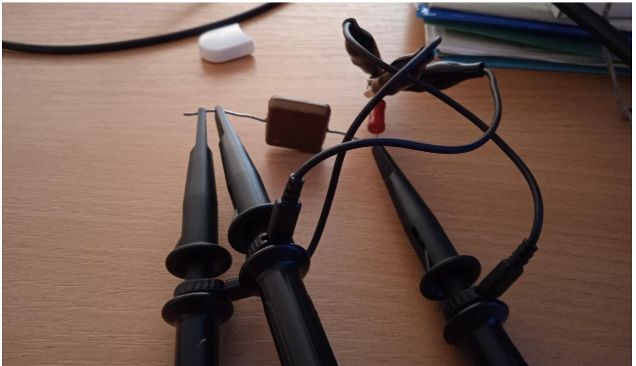
Рисунок 6.14 – Макет - RC - ланцюжок, що диференціює
