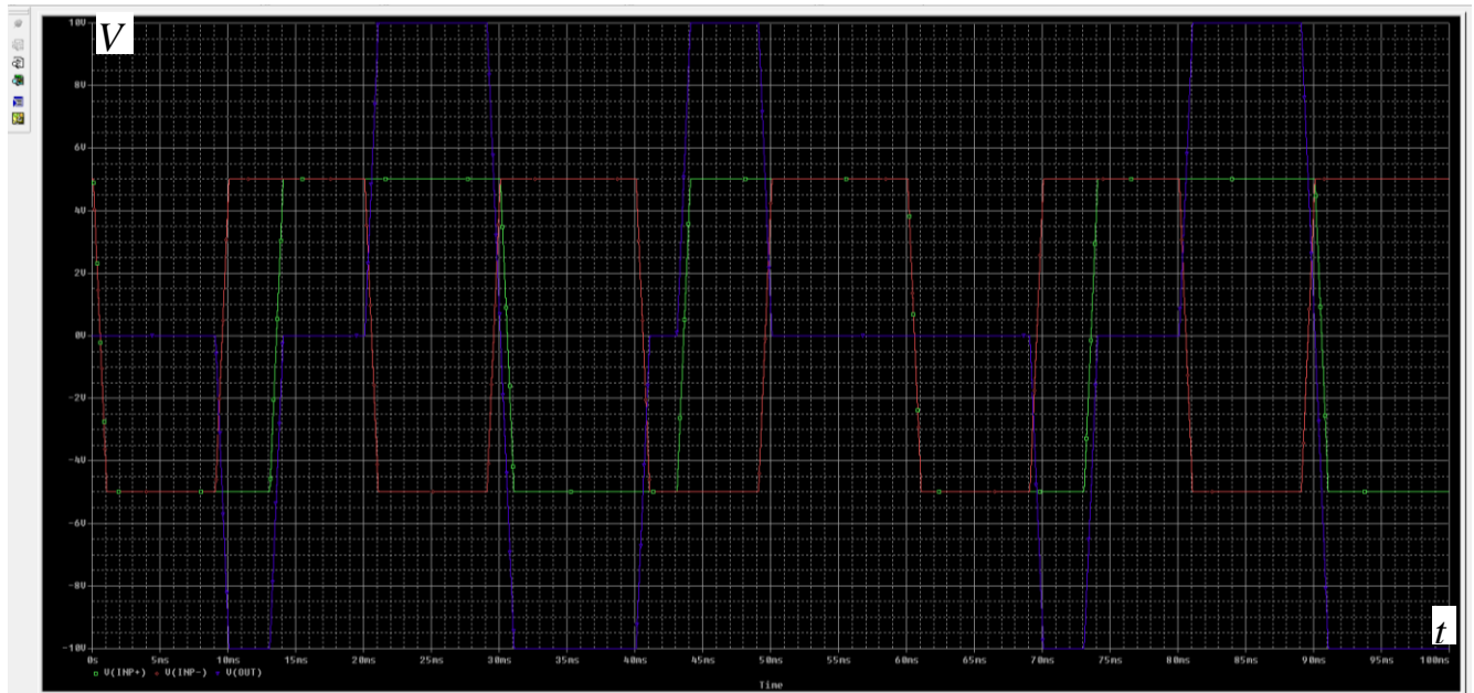
Рисунок 4.35 – Часові діаграми вхідних сигналів та вихідного, як різницю вхідних.
