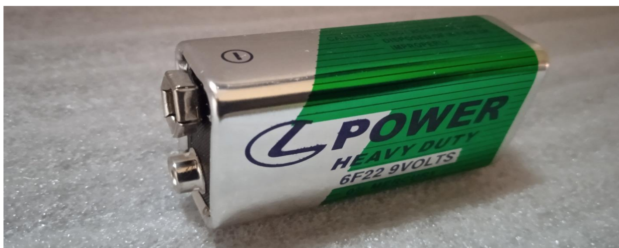
Рисунок 1.2 – Батарея елементів живлення галетного типу
