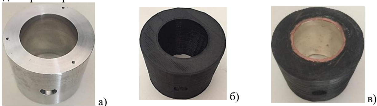
Рисунок 21 – ЕР: металевий (а); пластиковий до (б) та після (в) металізації
