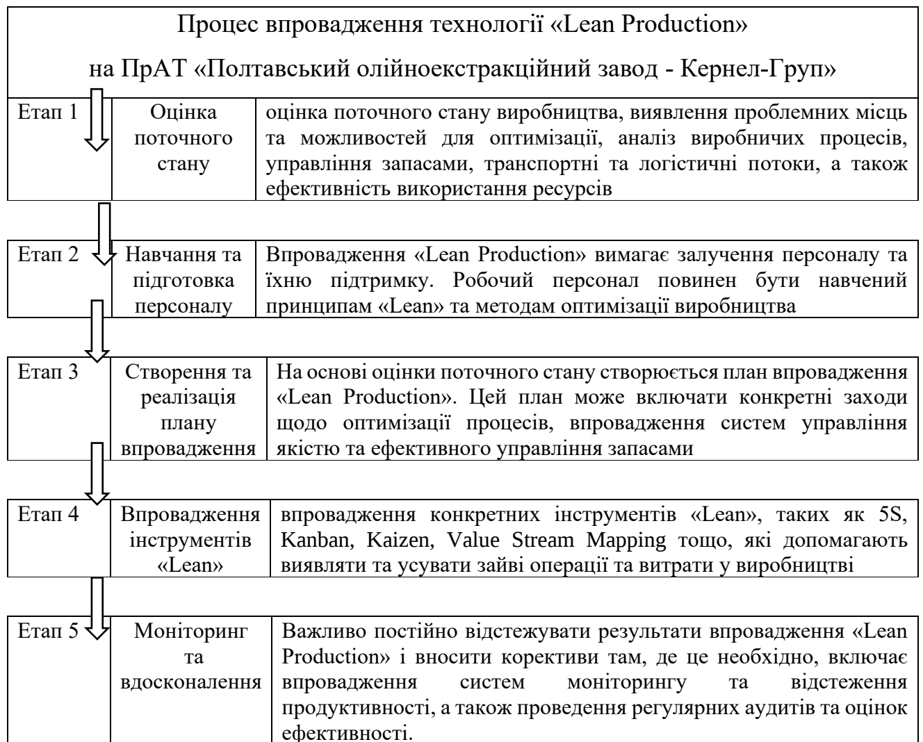
Рисунок 3.1 – Процес впровадження технології «Lean Production» на ПрАТ «Полтавський олійноекстракційний завод – Кернел-Груп» в умовах воєнного стану
