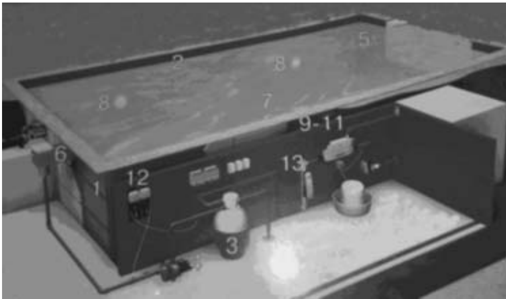
Рис. 1. Модель системи водоснабження басейна
