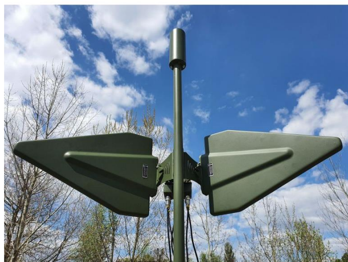
б) Всенаправлена біконусна антена діапазону 500-6000 МГц та 2 логоперіодичні антени діапазону 500-6000 МГц
