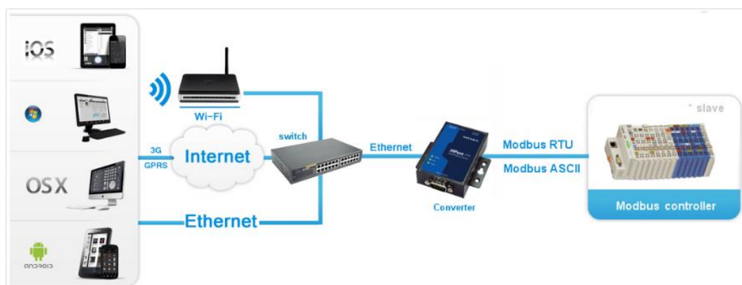
Рисунок 1.5 – Сервер Modbus TCP в RTU [2]
