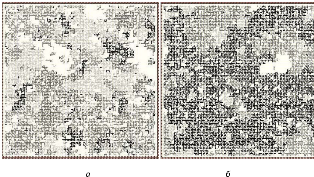
Рис.4.2 Вид перколяційної системи поблизу порога протікання: а - нижче порога, без перколяції; б - вище порога, з протіканням
