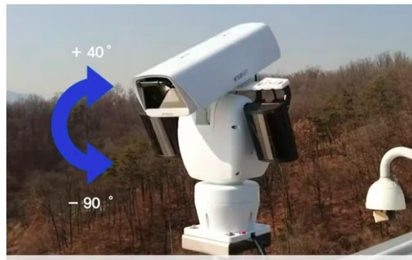
Рис.1.11. Комплекс з поворотно-похилого механізму та фіксованої корпусної камери.
