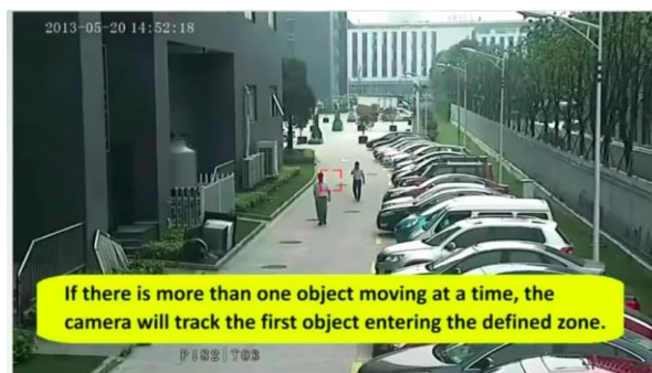
Рис.1.8. Приклад роботи PTZ камери з функцією трекінгу руху
