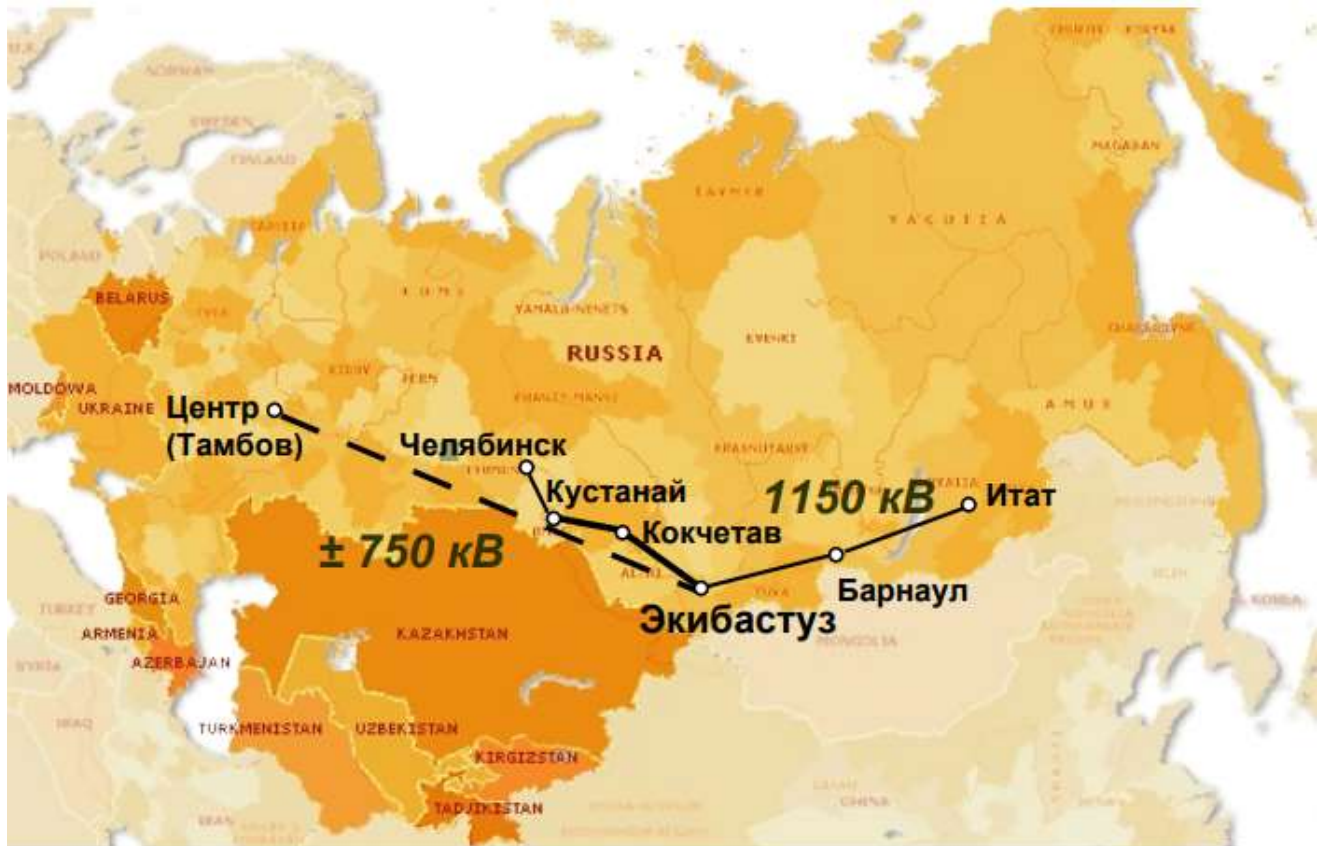
Рис.1.1. Схема ЛЕП 1150 кВ змінного струму Сибір-Казахстан-Урал і 1500 кВ ( \pm 750 кВ) постійного струму Екібастуз-Центр (пунктир)
