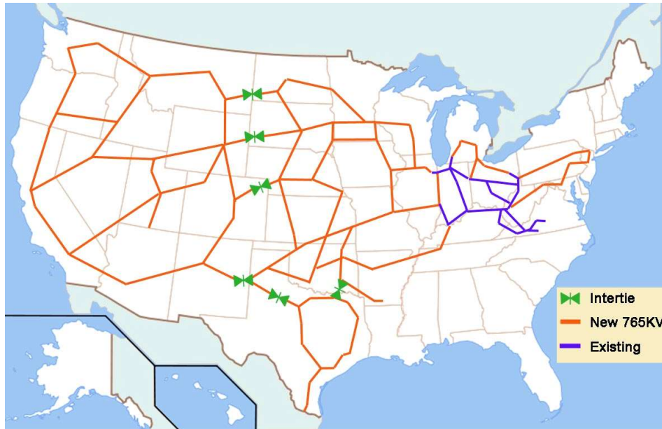
Рис. 1.5. Мережа магістральних ліній електропередавання 765 кВ в США
