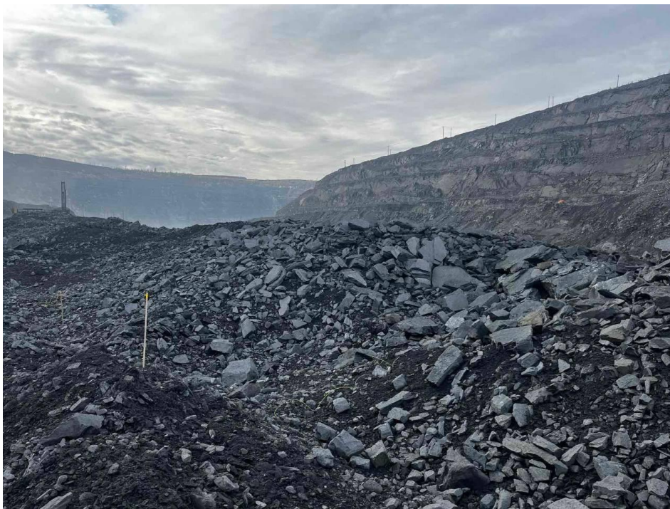
Рис. 4.12. Розвал гірничої маси на промисловому блоці після вибуху
