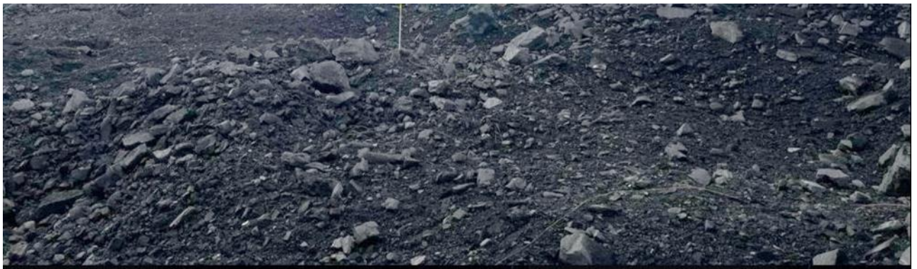
Рис. 4.17. Розвал гірничої маси після вибухового руйнування масиву на експериментальному блоці
