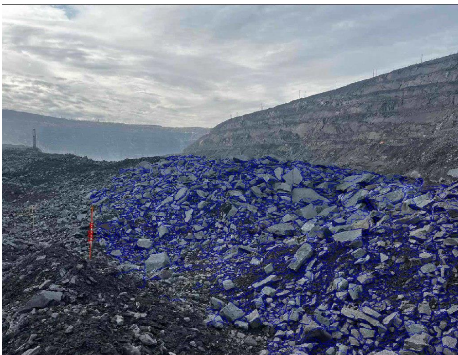
Рис. 4.13. Фрагментація шматків гірничої маси на поверхні промислового блоку у програмному комплексі WipWare
