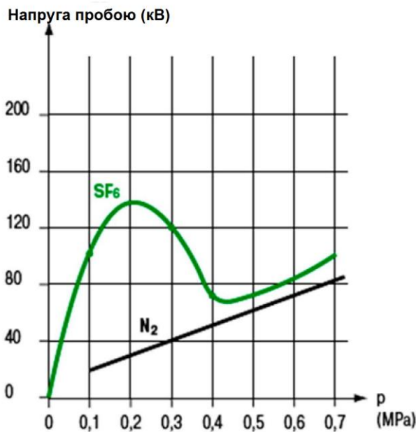
Рис. 5.1. Залежність електричної міцності елегазу від тиску
