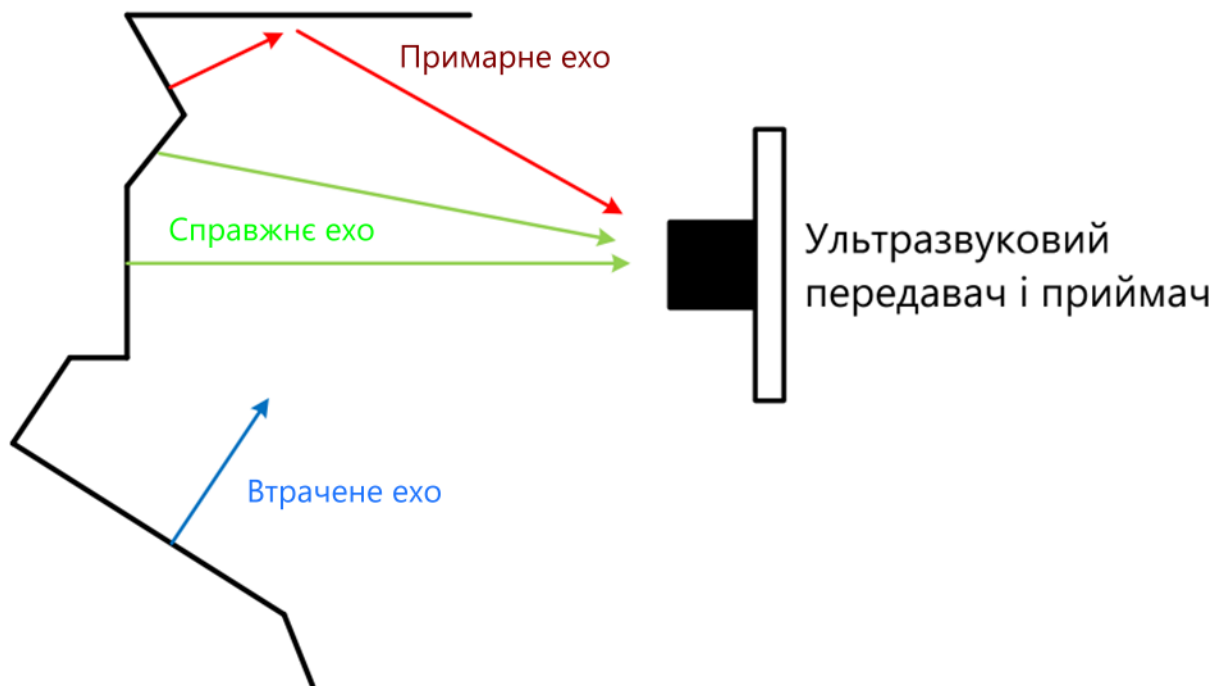
Рисунок 1.3. Відбиття від поверхонь з різною кутом нахилу
