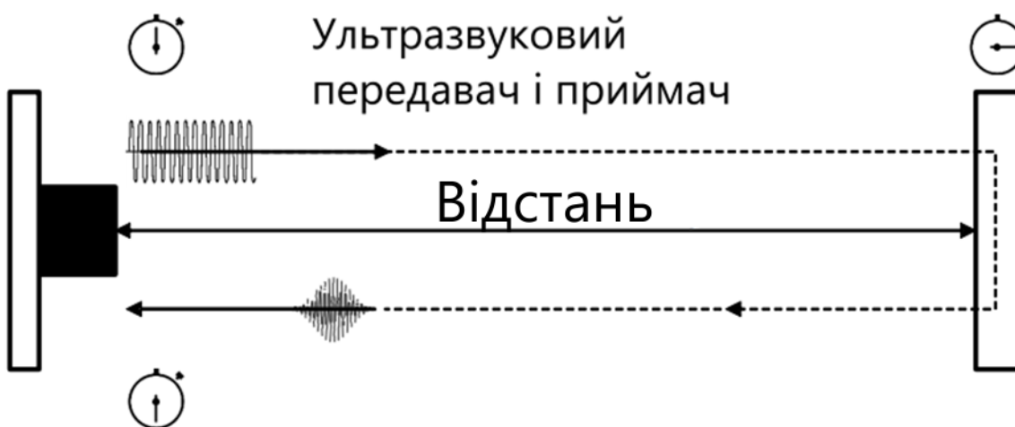
Рисунок 1.1. Вимірювання часу проходження
