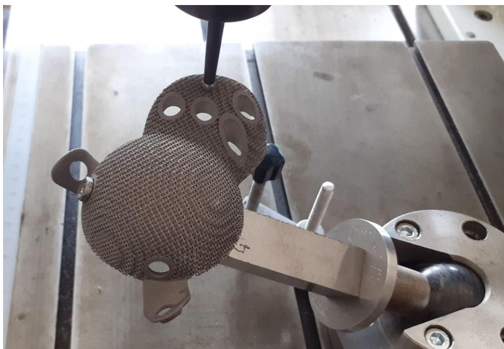
Рисунок 3.4 – Вимірювання поверхні фланцю титанового імпланту
