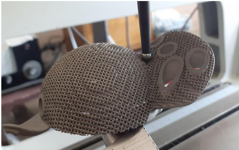
Рисунок 3.5 – Проблема доступу до місця стику двох поверхонь
