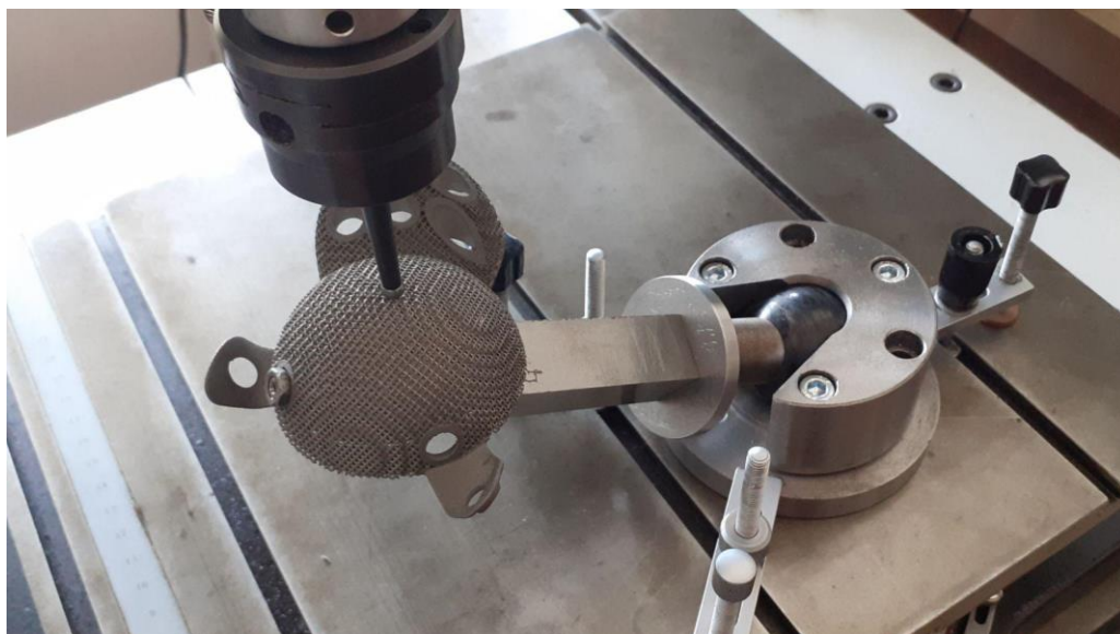
Рисунок 3.3 – Вимірювання поверхні півсфери титанового імпланту
