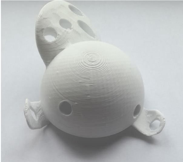
Рисунок 1.9 – Прототип, надрукований за допомогою технології FDM
