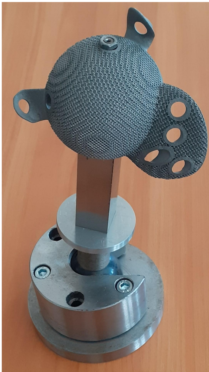
Рисунок 3.2 – Оснащення для закріплення деталей під час вимірювання
