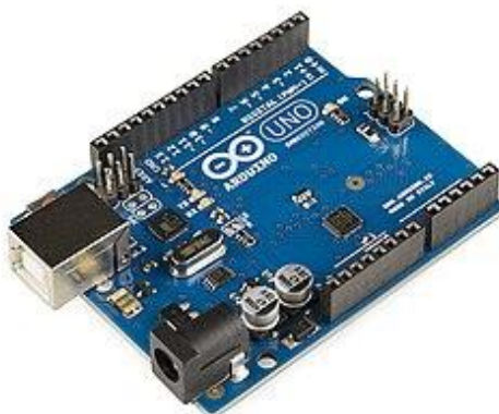
Рисунок 2.2 – Зовнішній вигляд мікроконтролерної плати Arduino UNO
