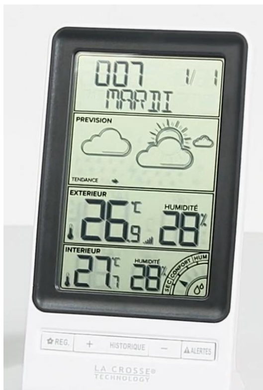
Рисунок 1.3 – Зовнішній вигляд метеостанції La Crosse Technology
