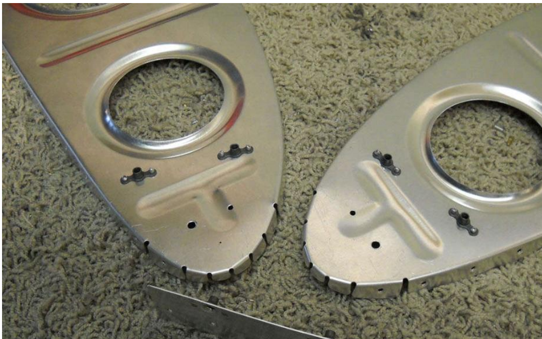
Рис. 1.3 Один з підходів штампування носової частини нервюри
