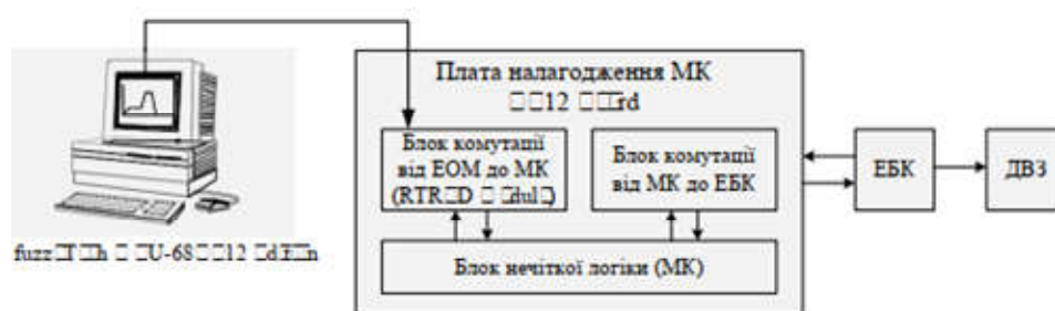
Рис. 3.42. Класична спрощена структурна схема підключення системи керування до ДВЗ [33]
