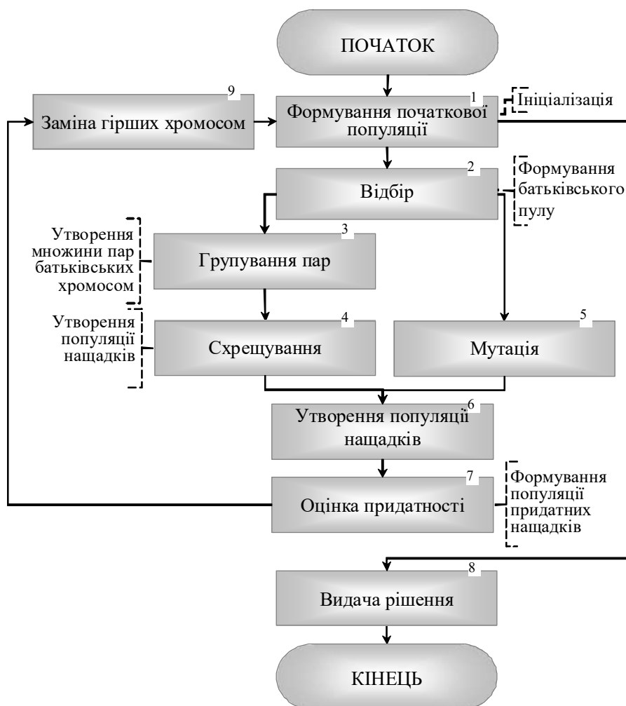
Рис. 3.44. Узагальнена блок-схема роботи генетичного алгоритму
