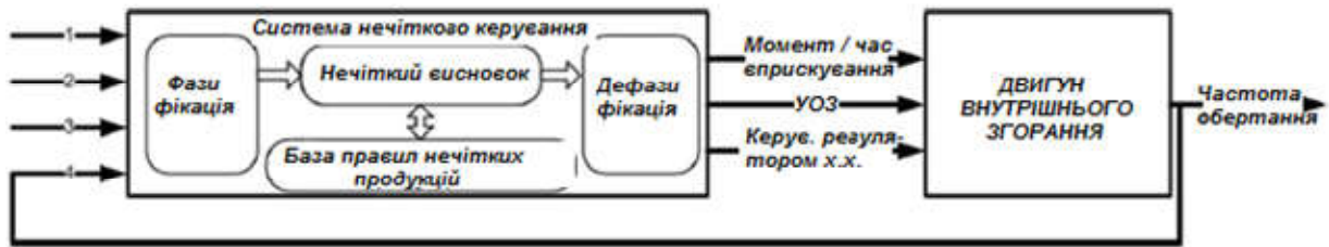
Рис.3.35. Логічна структура системи керування ДВЗ на основі нечіткої логіки [33]
