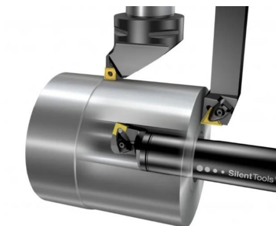
Рисунок 2.2 – Токарне оброблення циліндричних поверхонь
