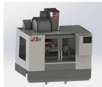
Верстат HAAS VF-2TY, що укомплектовано обертовим столом з лещатами
