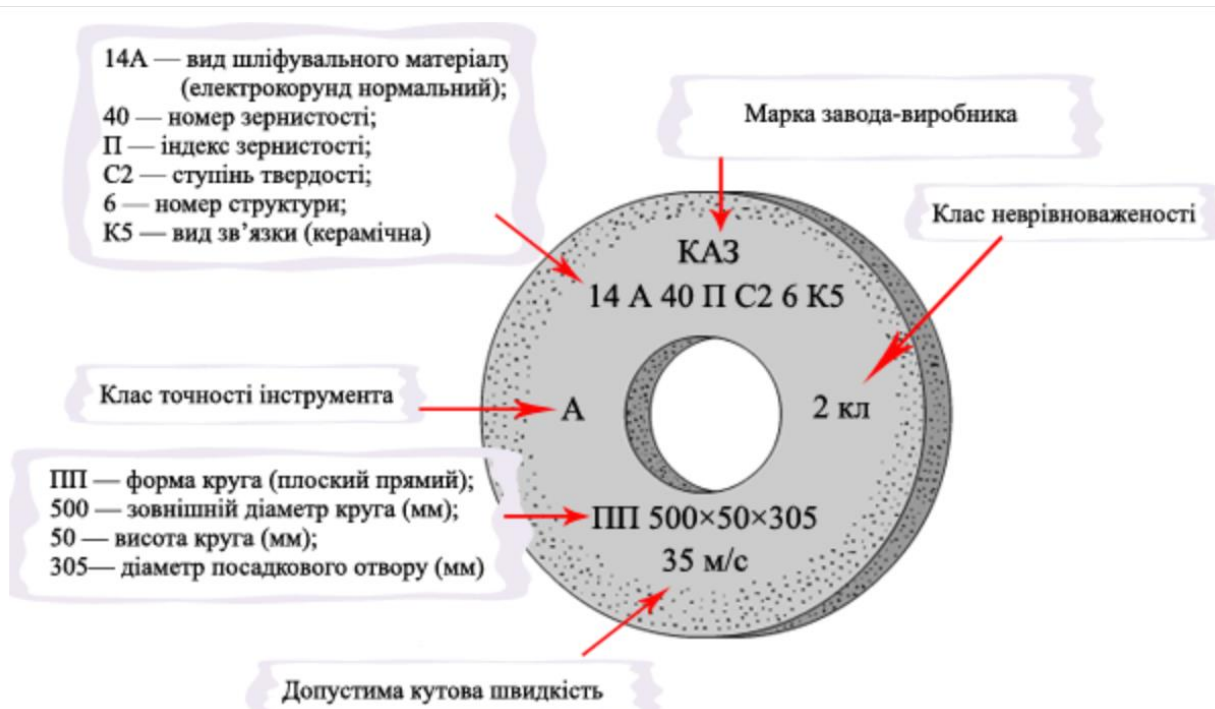
Рисунок 2.7 – Приклад маркування шліфувального інструмента
