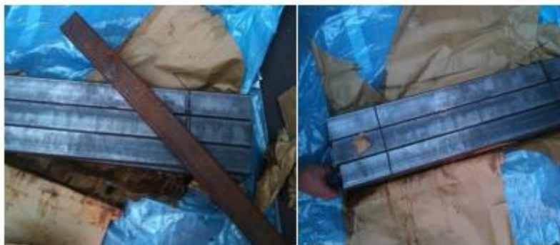
Рисунок – Зовнішній вигляд поверхні пакета труб після застосування тимчасового протикорозійного захисту і не упакованого металу
