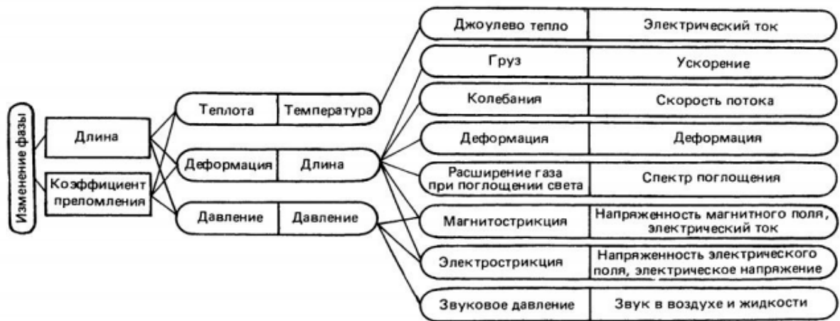
Рис. 3.2. Функціональні можливості волоконно-оптичного чутливого елемента, що працює на основі зміни фази світла
