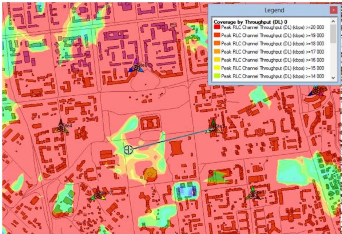
Рисунок 4.65 – Результат моделювання розподілу швидкості передавання даних у напрямку вниз
