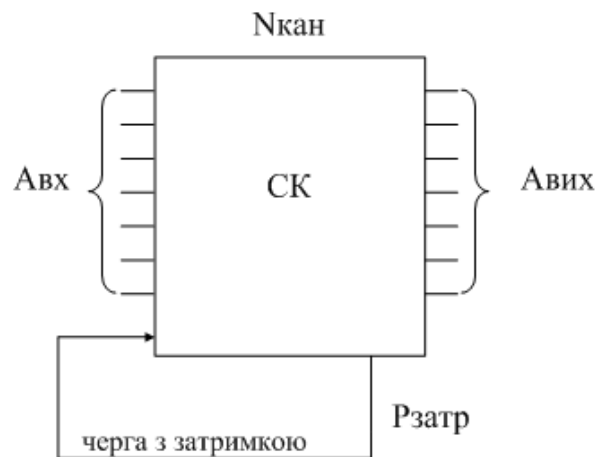
Рисунок 1.6 – Система комутації з затримкою виклику
