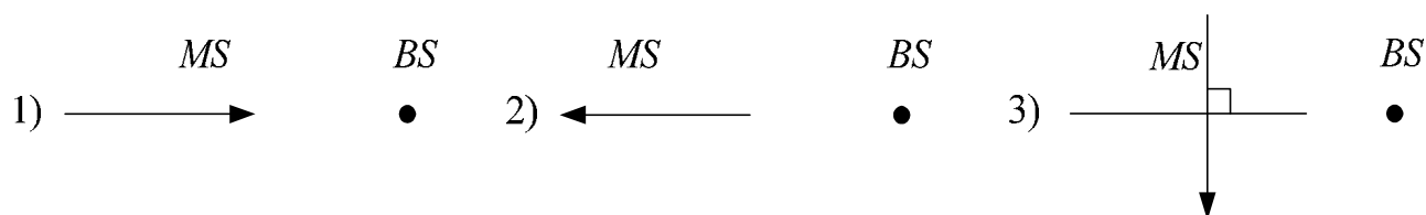
Рисунок 2.6 – Розташування МС відносно БС
