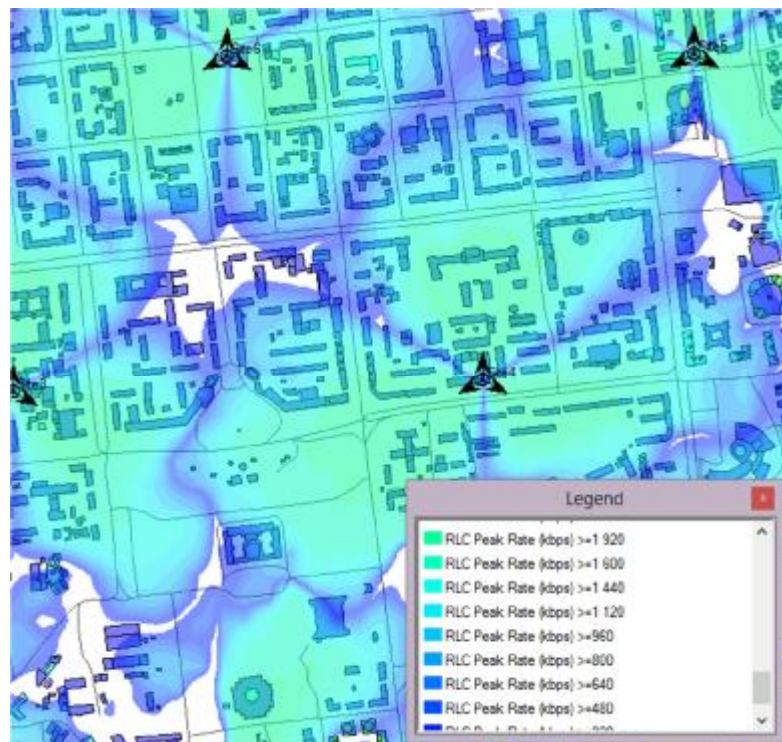
Рисунок 4.56 – Результат моделювання покриття технологією HSDPA
