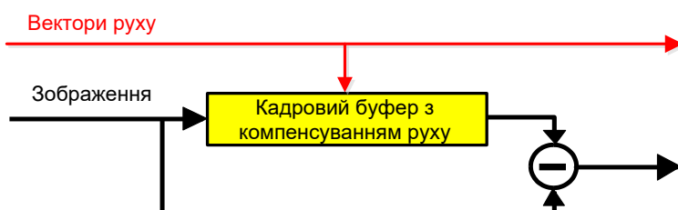
Рисунок 2.6 – Схема обчислення міжкадрових поелементних різниць для прогнозування кадру
