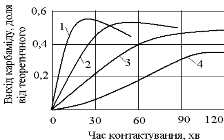
Рисунок 19.2 – Залежність виходу карбаміду із карбамату амонію від тривалості процесу та температури [5, 16].
